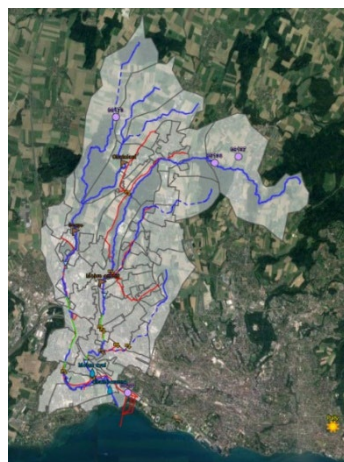
Figure 1: Bassin versant de la Chamberonne, tel que modélisé par la société Hydrique.ch et vue de la station de mesure UNIL qui dispose d'information de débit et de concentration pour valider le modèle
